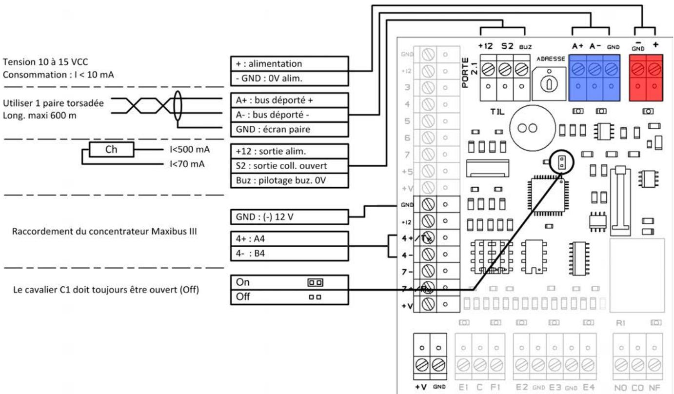
**Protection des équipements :** Afin d'assurer un parfait fonctionnement des équipements et éviter les interférences, raccorder le 0 volt des cartes électroniques à la terre.
